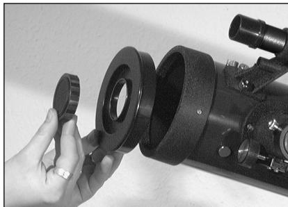
L'ouverture du tube est munie d'un cache-poussière et d'un pare-soleil, afin de protéger de la poussière l'intérieur de votre télescope. Ôtez ces deux cache-poussière avant de faire des observations.
