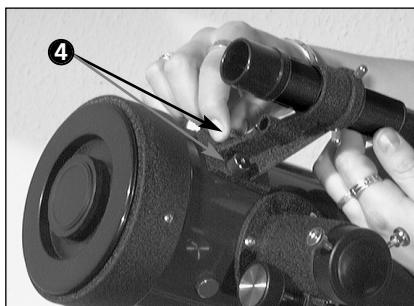
Pour monter le chercheur (2b) commencez par desserrer ses vis de serrage (4).
