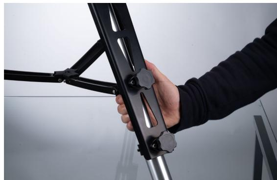
Lorsque le trépied est ouvert, solidement bloqué avec les pieds ajustés par l'utilisateur, il est possible d'installer la monture.
