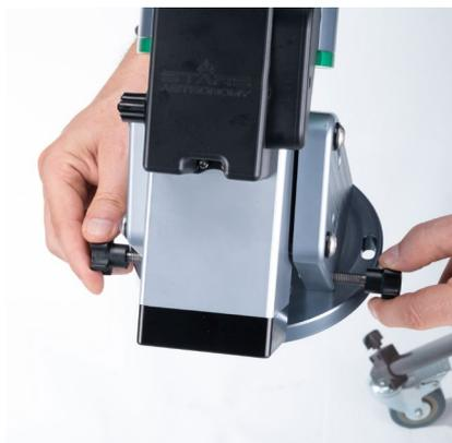
Les trous de la base de la monture doivent correspondre aux goupilles de réglage de l'azimut installées sur le trépied
