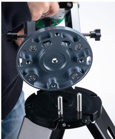
Placez la monture sur le trépied et serrez les deux boutons de réglage de l'azimut sur les goupilles correspondantes
