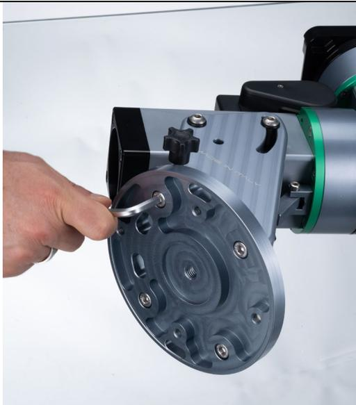
Retirez les deux boulons qui fixent le côté latéral gauche de la base de la monture sur l'axe RA de la monture
