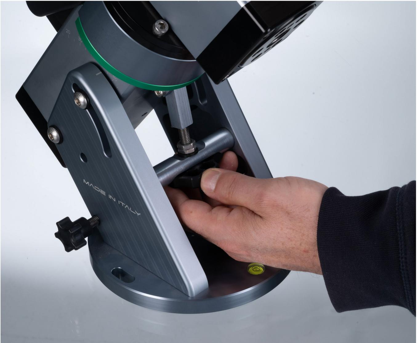
REMARQUE : Le réglage fin de la latitude doit être effectué avec les quatre boulons de fixation latéraux desserrés. Une fois la latitude réglée, ils doivent être resserrés.
