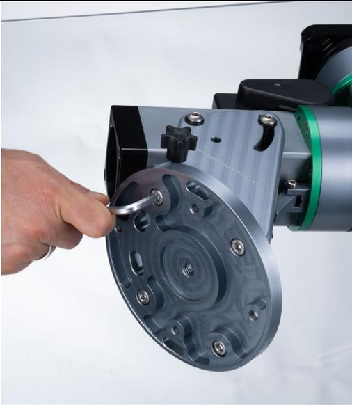
Rimuovere i due bulloni che fissano il lato sinistro della base della montatura sull'asse RA della montatura
