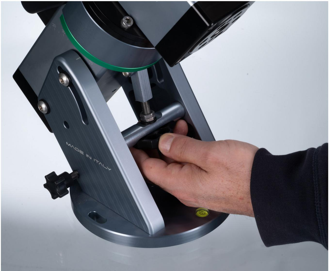
NOTA: La regolazione fine della latitudine deve essere effettuata con i quattro bulloni di fissaggio delle staffe laterali allentati. Quando la latitudine è stata impostata, devono essere serrati nuovamente.
