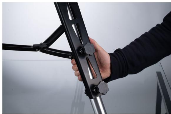
Quando il treppiede è aperto, bloccato saldamente con l'altezza delle gambe regolata dall'utente, è possibile installare la montatura.
