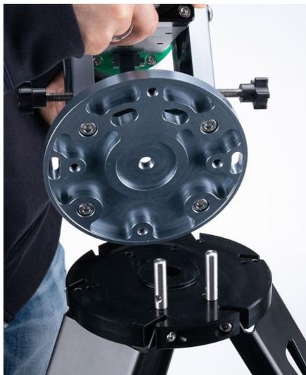
Posizionare la montatura sul treppiede e stringere le due manopole di regolazione dell'azimut sui perni corrispondenti
